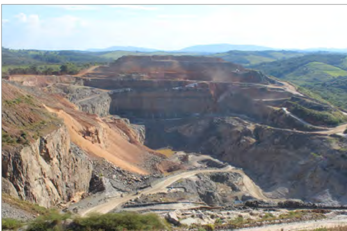
Figura 9: A mina Mibra, da AMG Mineração, no estado de Minas Gerais, Brasil, contém 20,3 Mt de recursos medidos e indicados. Atualmente, tem capacidade para produzir cerca de 135 t de Ta 2 O 5 por ano (foto: T.I.C.)
