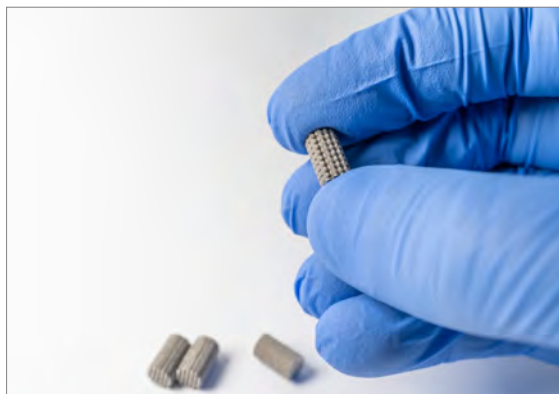
O artigo vencedor de 2019 analisou as propriedades de estruturas feitas de liga titânio-tântalo (Ti-25Ta) (foto: N. Soro)
